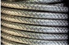
Für das Rohrbündel der Baureihen CPR-S, CPR-R & CPR-E kommen kreuzgedrallte Edelstahlrohre zum Einsatz. Diese werden gegenläufig in mehreren Lagen um einen Kern gewickelt. Durch die Drallung erhält man auf der Rohrinneinnenseite eine Profilierung, wodurch eine turbulente Strömung erzeugt wird. Damit verbunden sind ein wesentlich besserer Wärmeübergang und ein Selbstreinigungseffekt der Wärmeübertragungsfläche.
