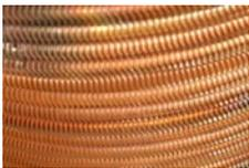
In den Kupferrohrbündel-Wärmetauschern werden hochberippte Kupferrohre eingesetzt. Diese haben analog zu den Edelstahlrohren eine profilierte Rohrinneinnenseite, so dass im Rohr eine turbulente Strömung mit den Vorteilen des besseren Wärmeübergangs und des Selbstreinigungseffekts erzielt wird. Gleichzeitig sorgen die Rippen auf der Außenseite des Rohres für eine Vergrößerung der Oberfläche.
