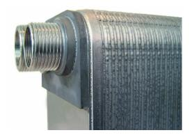
Beim Zusammenfügen wird jede zweite Platte in der Ebene um 180° gedreht, wodurch sich zwei voneinander getrennte Strömungsräume bilden, in denen die Medien im Gegenstrom geführt werden.
